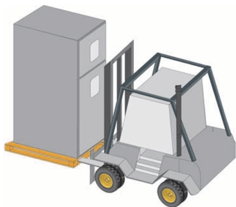
Verladen einer Schaltanlage mittels Hublader (Hubtragarme untergreifen Feldstoß)
