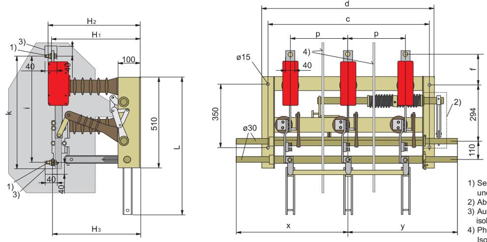
Abb. 3: Bauform H 27 EA mit unten angebautem Erdungsschalter
