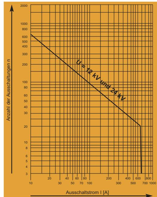
Wartungsfreie Lastausschaltungen in Abhängigkeit vom Ausschaltstrom bei  $\cos \phi \geq 0,7$
