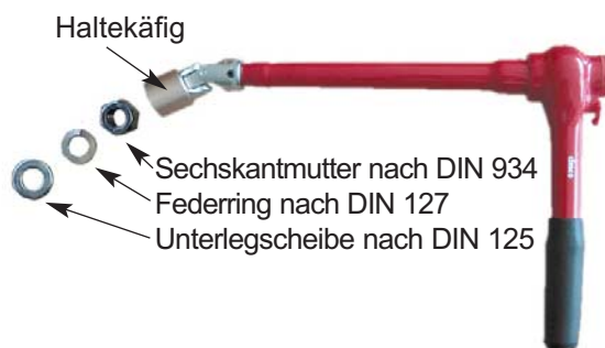
Abb. 10: Isoliersteckschlüssel mit Steckschlüssel-Einsatz SW 19 mit Mutter, Federring und Scheibe
