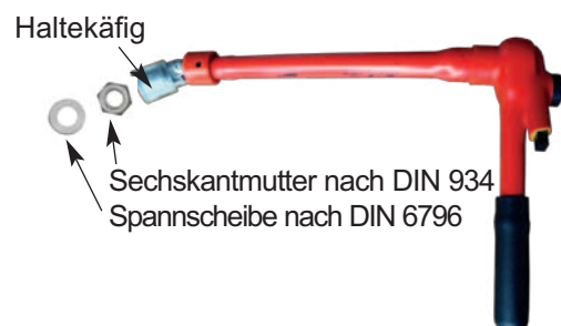
Abb. 11: Isoliersteckschlüssel mit Steckschlüssel-Einsatz SW 19 mit Mutter und Spannscheibe
