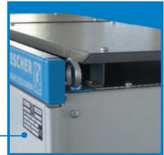
Frontblende zur Beschriftung, Belüftungssystem oben
