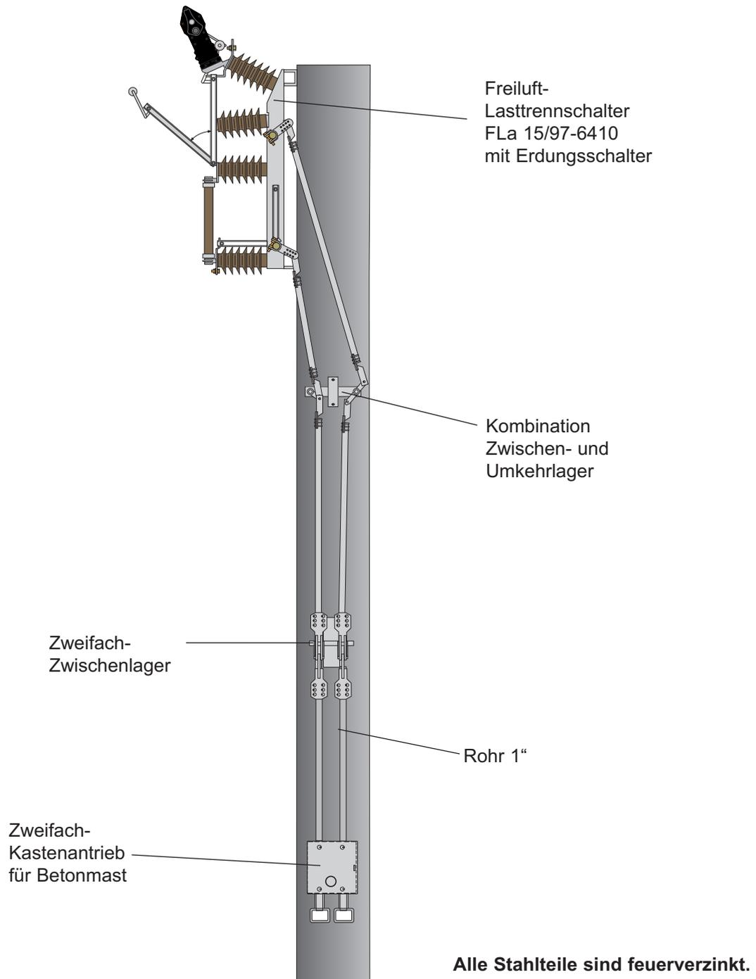
Abb. 28: Beispielhaft dargestellt Zweifach-Kastenantrieb für Betonmasten
