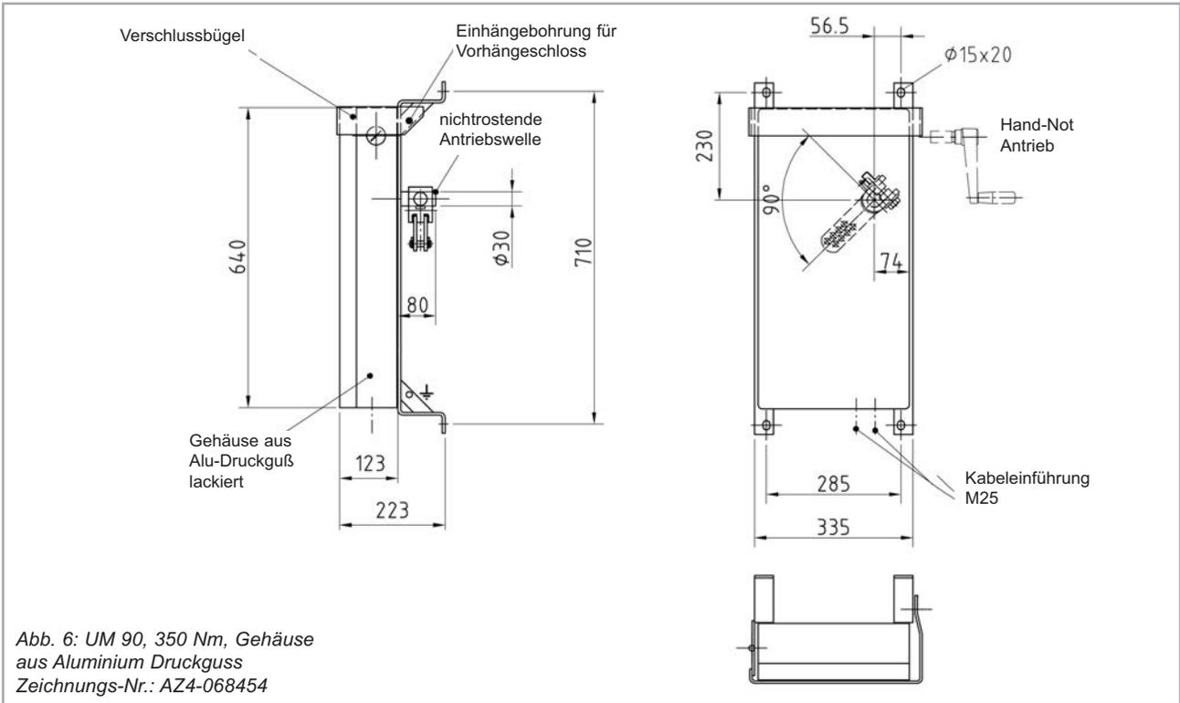
**Freiluft Universal Motorantriebe UM 90 und UM 100 Edelstahlgehäuse - Zeichnung**
