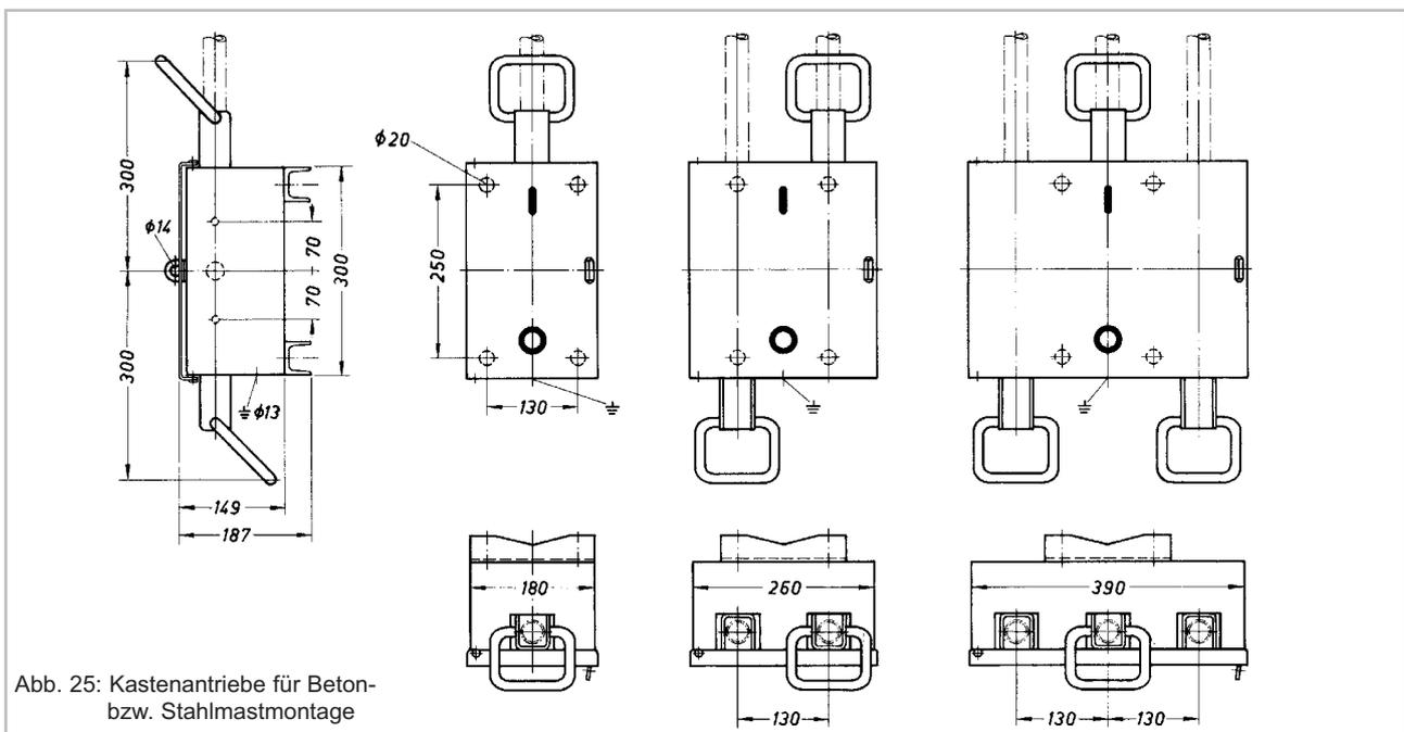
Abb. 25: Kastenantriebe für Beton- bzw. Stahlmastmontage
