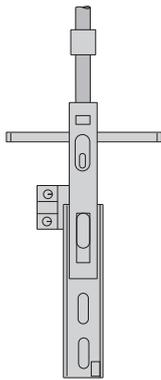
Abb. 15: L-Antrieb für Beton- bzw. Stahlmast
