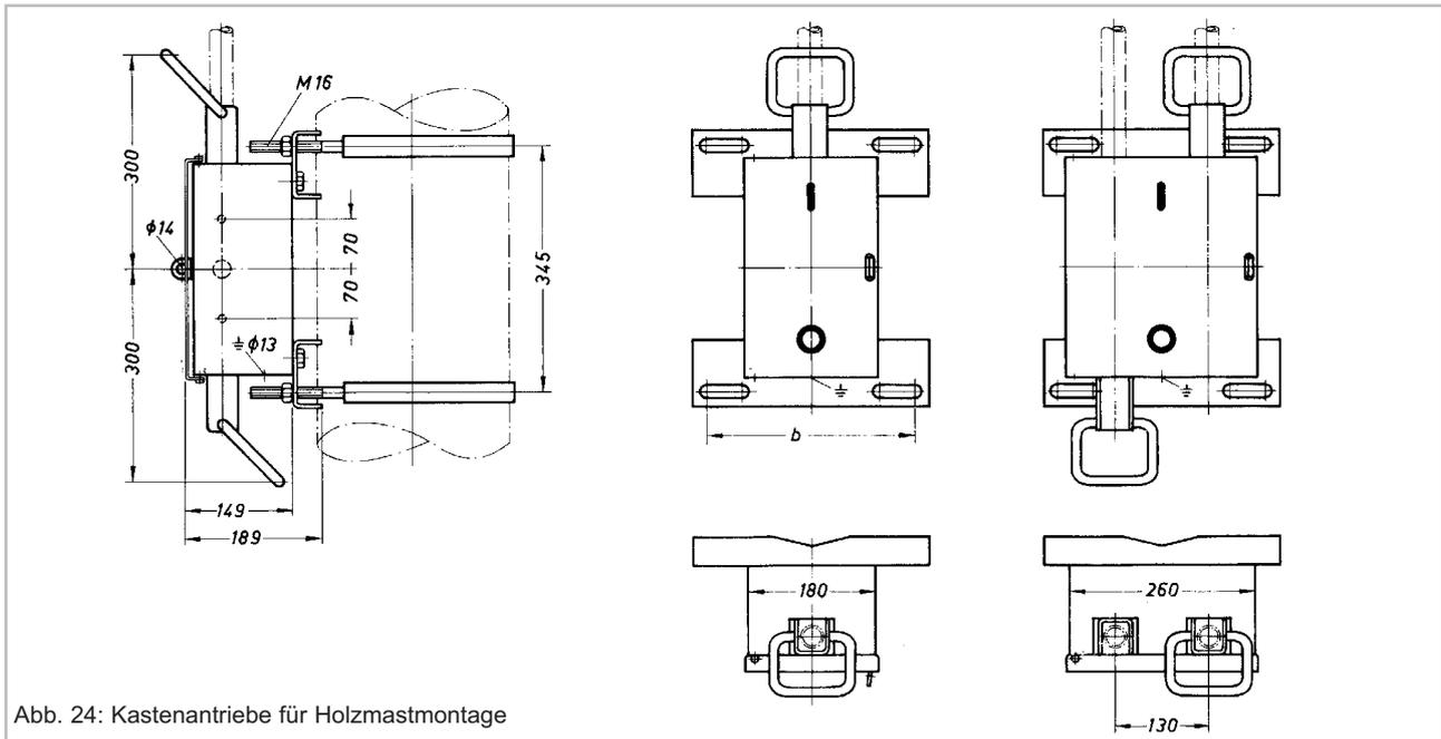
Abb. 24: Kastenantriebe für Holzmastmontage
