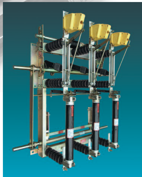
Lastschalter-Sicherungs-Kombination mit mechanischer Auslöseverzögerung Typ H 22 SEA, Ur 24 kV, Ir 630 / 125 A
