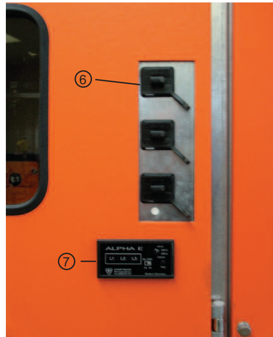
Bild: Kapazitive Schnittstelle und Kurzschlussanzeiger
